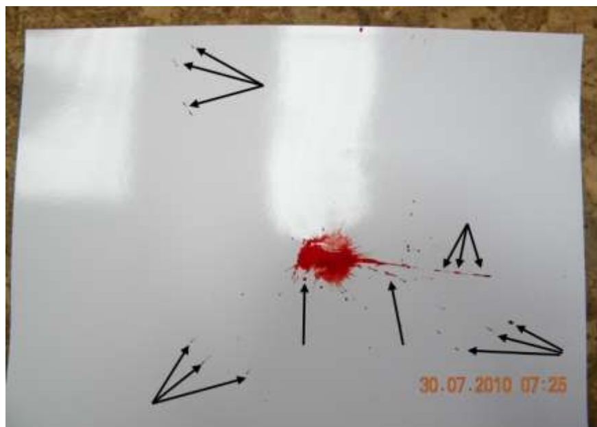
Рисунок 56 – Удар квадратным бойком слесарного молотка (контуры отпечатка нечеткие, края неровные (мелко- и крупнозубчатые), следовоспринимающая поверхность – бумажные ровные обои. Стрелками указаны высокоскоростные вторичные брызги различной формы
