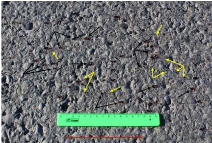
Рисунок 165 – Скорость движения автомобиля 60 км/ч, следовоспринимающая поверхность неровная (асфальт), объем – 0,069–0,083 мл. Красной стрелкой указано направление движения автомобиля, черными – первичные следы капель, желтыми – вторичные брызги
