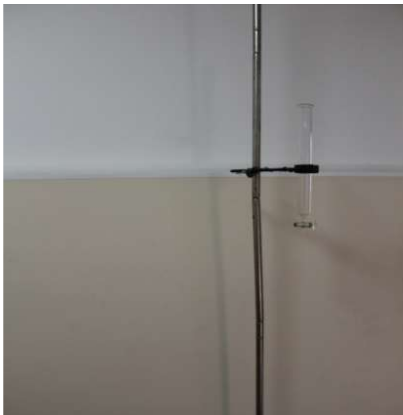
Рисунок 17 – Устройство, имитирующее свободное падение капле крови с неподвижного статического объекта
