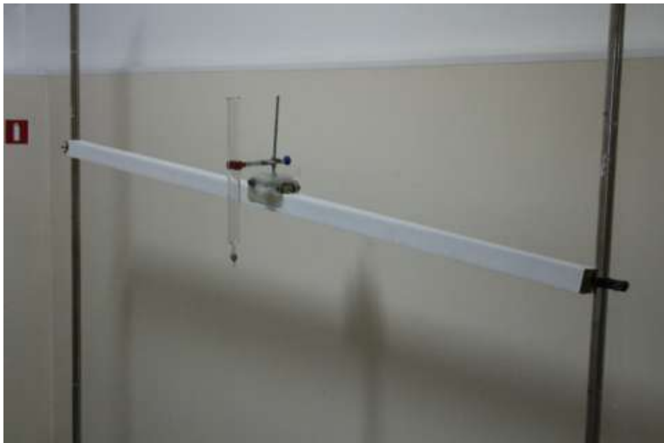
Рисунок 18 – Устройство, имитирующее падение капель крови с движущегося объекта
