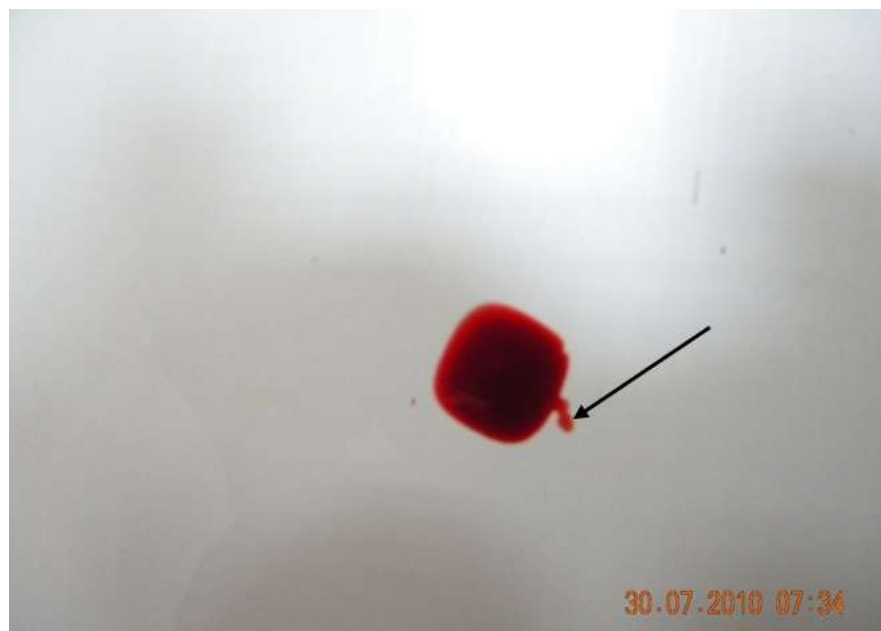
Рисунок 61 – Длительное давление квадратным бойком слесарного молотка, следовоспринимающая поверхность – офисная бумага с ровной поверхностью, контуры отпечатков четкие, края ровные. Стрелкой указан низкоскоростной элемент – извилистый короткий и узкий «динамический потек»
