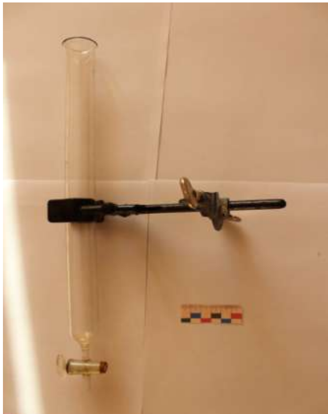
Рисунок 19 – Устройство, имитирующее кровотечение при движении автомобиля (бюретка с краником)
