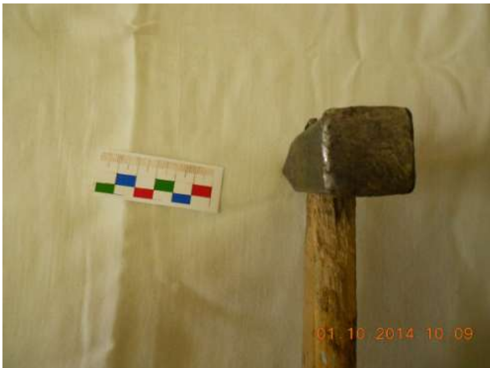
Рисунок 11 – Следообразующий предмет (молоток слесарный, вид квадратного бойка)
