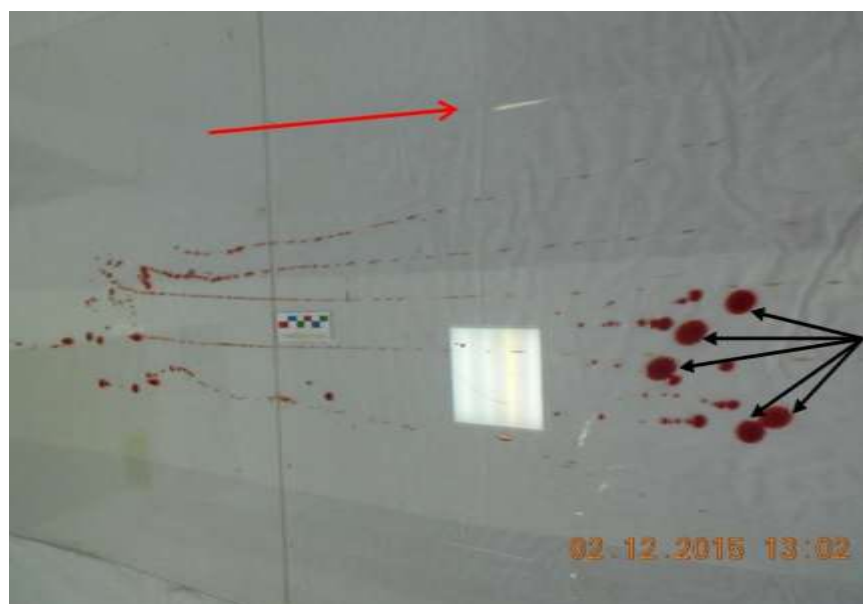
Рисунок 175 – Размахивание растопыренными пальцами на себя с резкой остановкой движения окровавленной руки, скорость 3,2 м/с, следовоспринимающая поверхность – стекло. Стрелками указаны: черными – дополнительные первичные следы крови на конечной части дорожки следов, красной – направление движения руки
