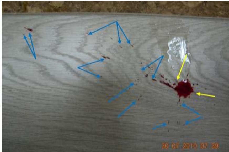
Рисунок 58 – Удар квадратным бойком слесарного молотка, следовоспринимающая поверхность – ламинат с неровной поверхностью.
