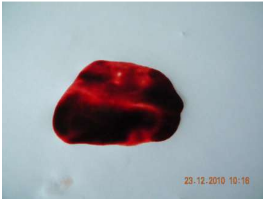
Рисунок 25 – Кратковременное давление кулаком, в брезентовой рабочей «верхонке», следовоспринимающая поверхность – офисная бумага (края отпечатка четкие, относительно ровные)
