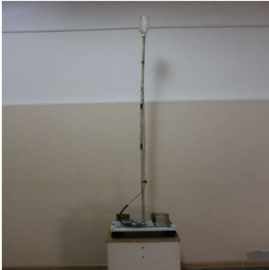
Рисунок 22 – Устройство, имитирующее артериальное кровотоечение (общий вид)
