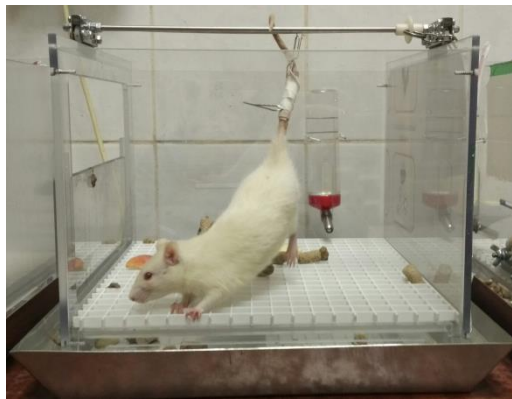
Рисунок 2.3. Экспериментальный стенд для моделирования эффектов микрогравитации с устройством фиксации животного в антиортостатическом положении.
