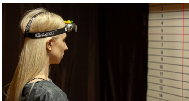
Рис. 2. Центровка головы в соответствии с лазерной указкой и линиями, расположенными на трафарете
