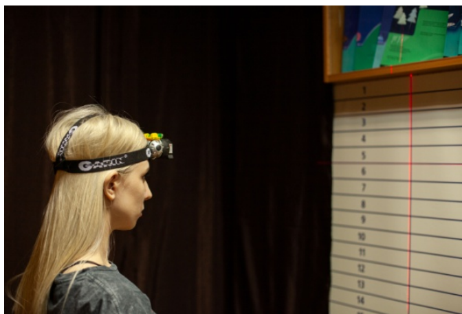
Рис. 2.5. Центровка головы в соответствии с лазерной указкой и линиями, расположенными на трафарете
