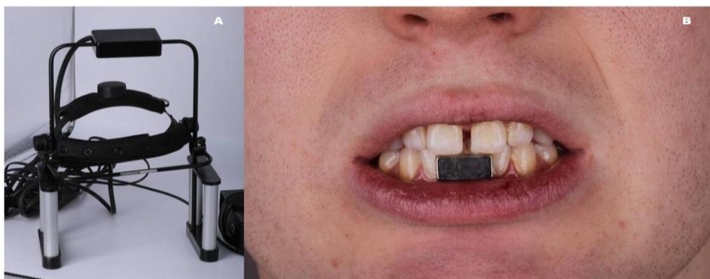
**Рисунок 10.** Фотография прибора для анализа движений нижней челюсти с магнитным датчиком. А) Электронный кинезиограф Jaw Tracker – 3D; В) Магнитный датчик, прикрепленный на фронтальной поверхности резцов нижней челюсти, позволяющий регистрировать, движения нижней челюсти в трех плоскостях.
