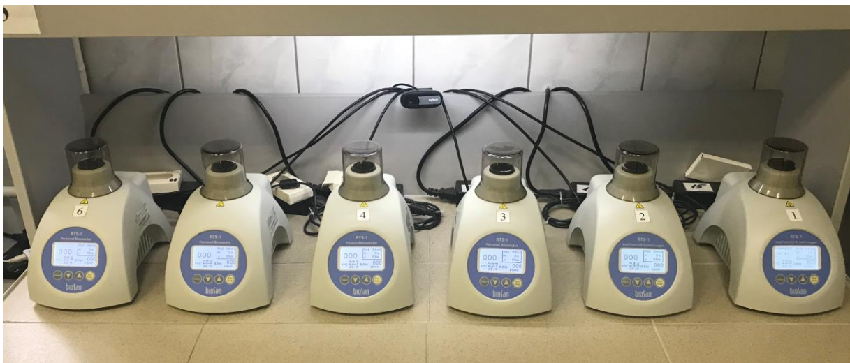
Рисунок 5 – Запараллеленная система программируемых культиваторов автоматического типа «RTS-1» (Biosan, Латвия)
