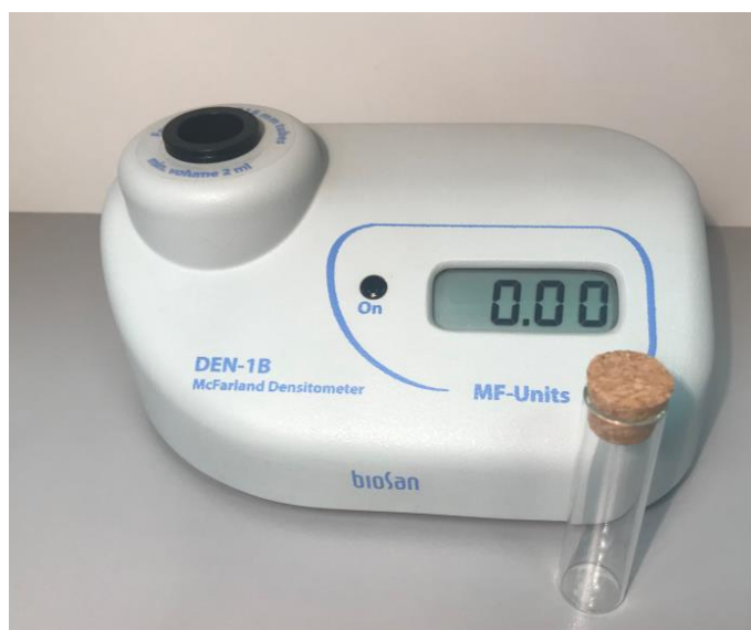
Рисунок 6 – Аппаратное измерение показателя оптической плотности DEN-1B (Biosan, Латвия).
