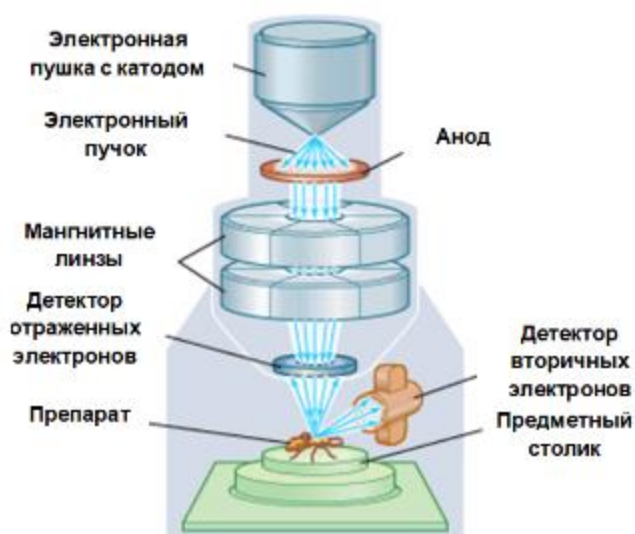
Рисунок 19 – Схема работы сканирующего электронного микроскопа
