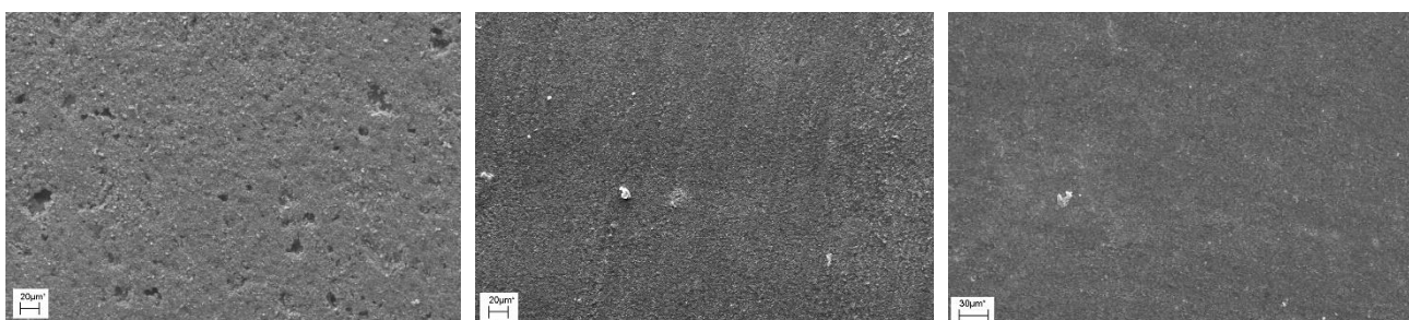
Рисунок 6 – Поверхность заготовки пломбировочного материала КФТ, увеличение 200. Различная концентрация наноалмазов: а – контроль, б – 0,5 % МДНА, в – 2,5 % МДНА
