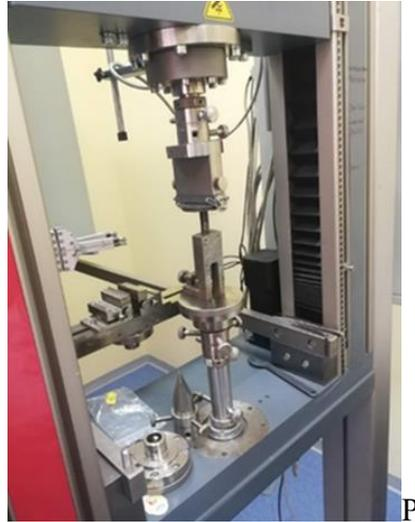
Рисунок 11 – Аппарат Zwick/Roell Z010 (Zwick, Германия)
