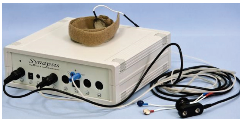
Рисунок 8. Четырехканальный электромиограф Synapsis (Нейротех, Россия), используемый в исследованиях
