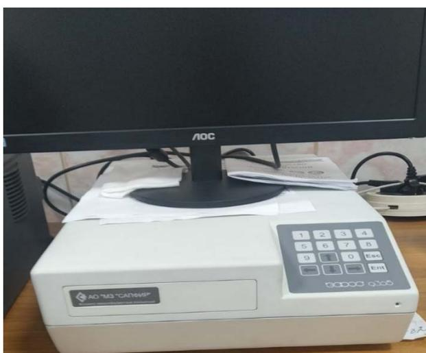
Рисунок 7. Биохимический фотометр иммуноферментный планшетный ЭФОС 9305 АО МЗ «Сапфир» (Россия) с монитором.
